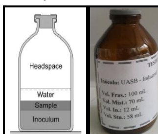
Figura 16 – Composição do meio de reação e frasco de 250 mL utilizado nos testes de biodegradabilidade.
