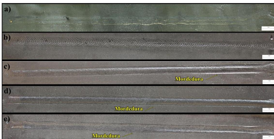
Amostras soldadas com frequência a) F0; b) F2; c) F4, d) F6 e e) F8.
