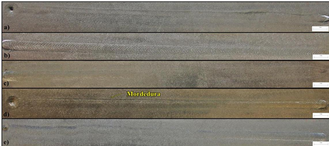
Amostras soldadas com frequência a) F0; b) F2; c) F4; d) F6 e e) F8.
