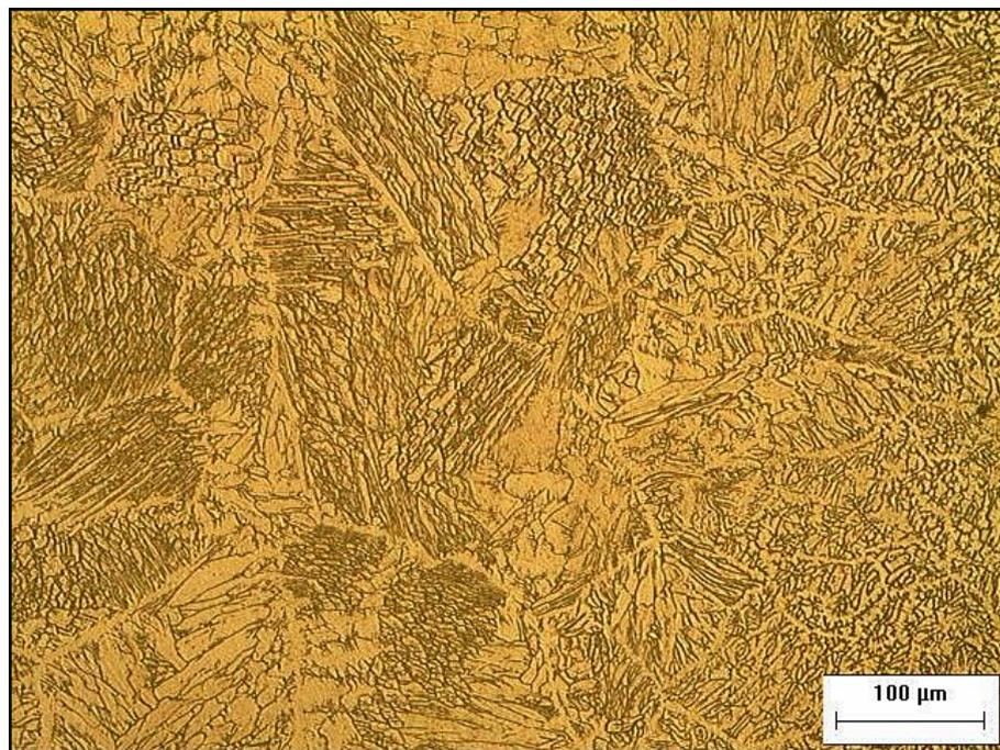
Amostra soldada com frequência F0. (Reagente HNO<sub>3</sub>; aumento de 200 X).
