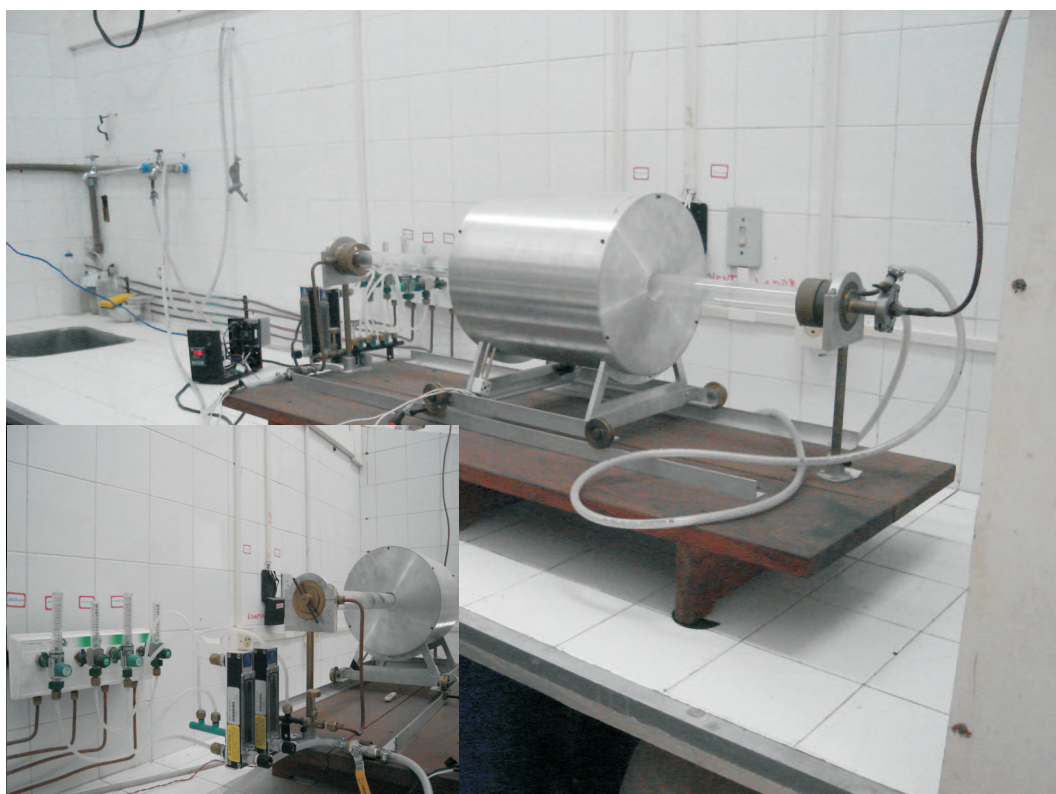
Figura 20: Visão geral do aparato experimental da técnica de deposição química a partir da fase vapor (CVD) usado em nosso trabalho.
