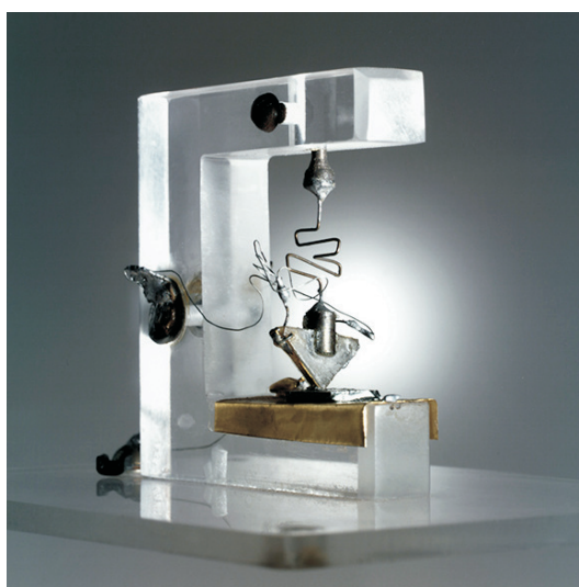
Figura 1: Primeiro transistor construído por Shockley, Brattain e Bardeen em 1947 [3].
