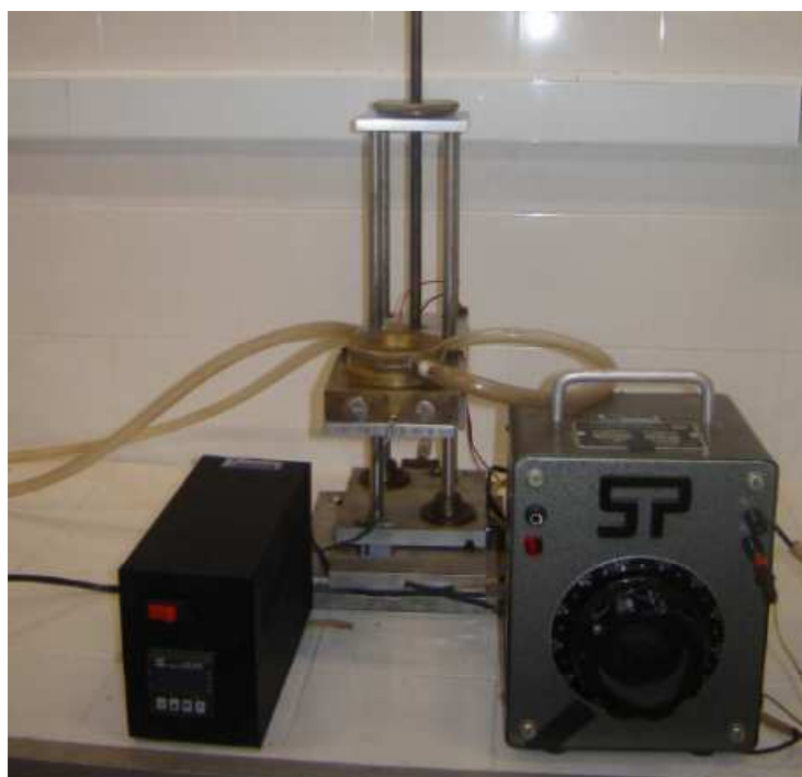
Figura 12 – Sistema utilizado nos experimentos de espectroscopia Raman a altas temperaturas.
