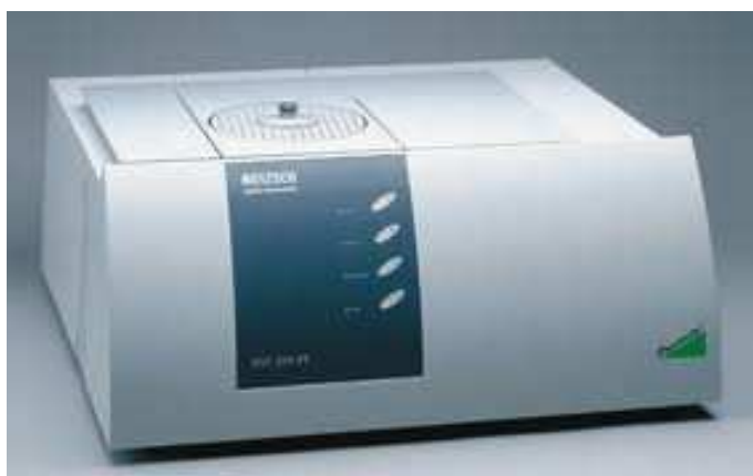
Figura 8 – DSC 204 F1 da Netzsch utilizado nos experimentos de calorimetria exploratória diferencial (DSC).
