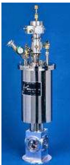
Figura 14 – Criostato utilizado nos experimentos de FT-IR em diferentes valores de temperaturas.
