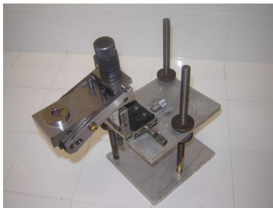
Figura 13: Célula de pressão utilizada sobre o suporte para as medidas de espalhamento Raman.
