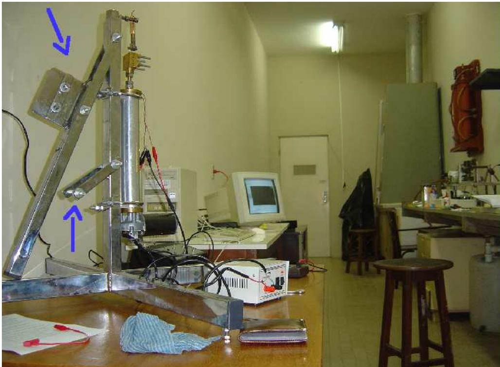
Figura 13: Hastes do Transdutor de Força
