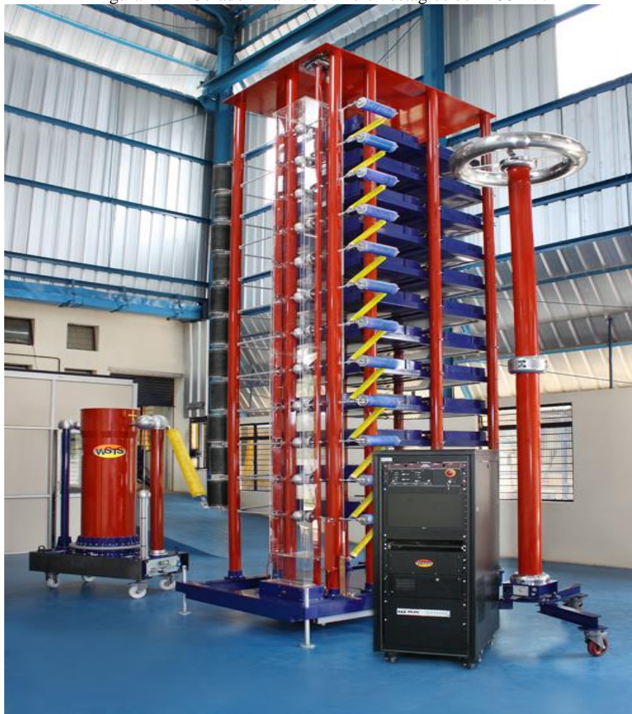
Figura 1.4 – Gerador Marx com multi-estágios de 1200 kV.
