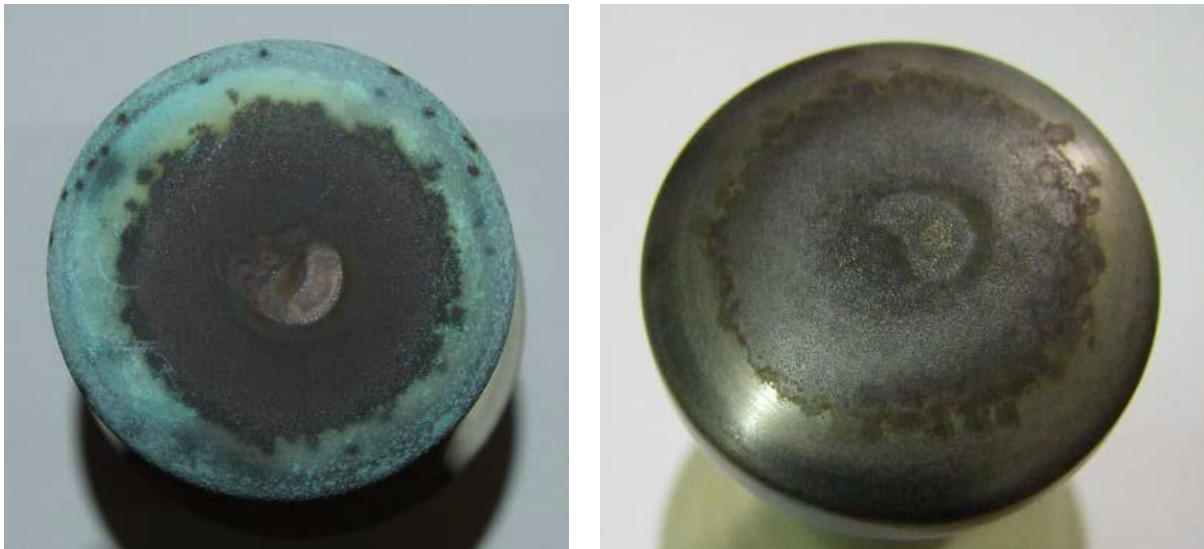
Figura 1.3 – Desgaste na superfície de uma spark gap .
