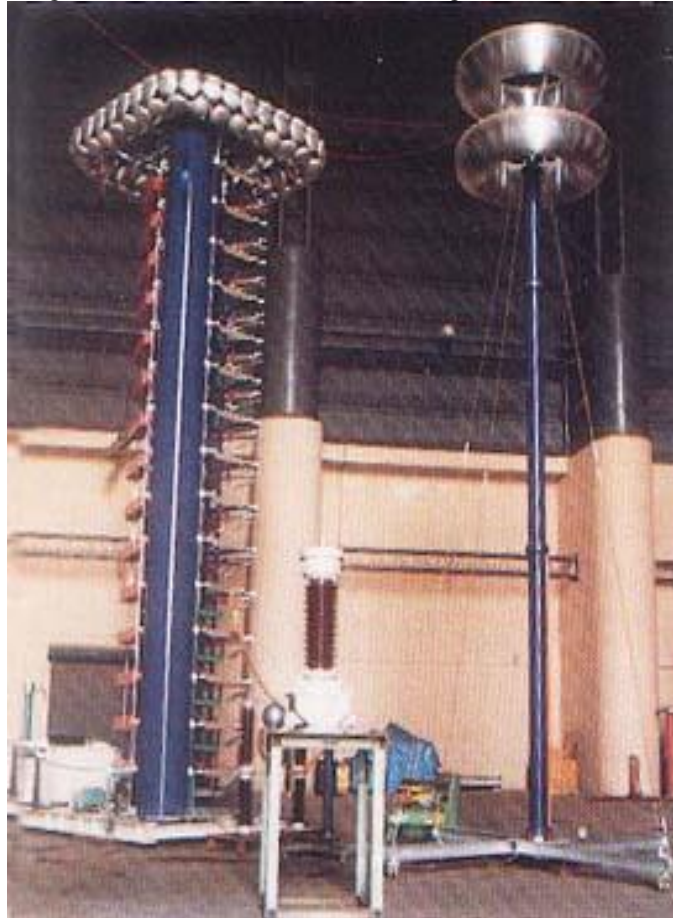
Figura 1.5 – Gerador Marx com 15 estágios, 3 MV, 150 kJ.
