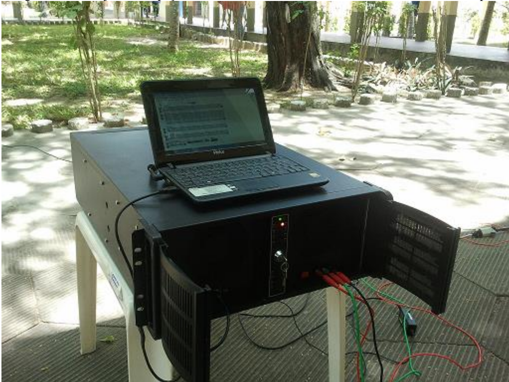
Figura 5.34 – Projeto de inspeção de sistemas de aterramentos montado em ensaio de campo.
