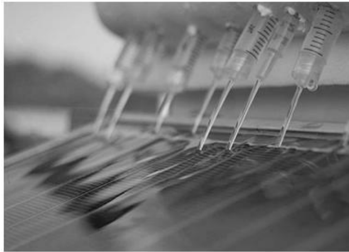
Figura 4 - Experimento com lâmina de água sobre a superfície do painel FV realizado no Rio de Janeiro, Brasil
