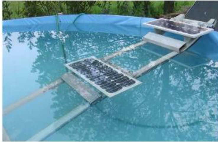
Figura 3 - Experimento FV submerso em Pisa na Itália
