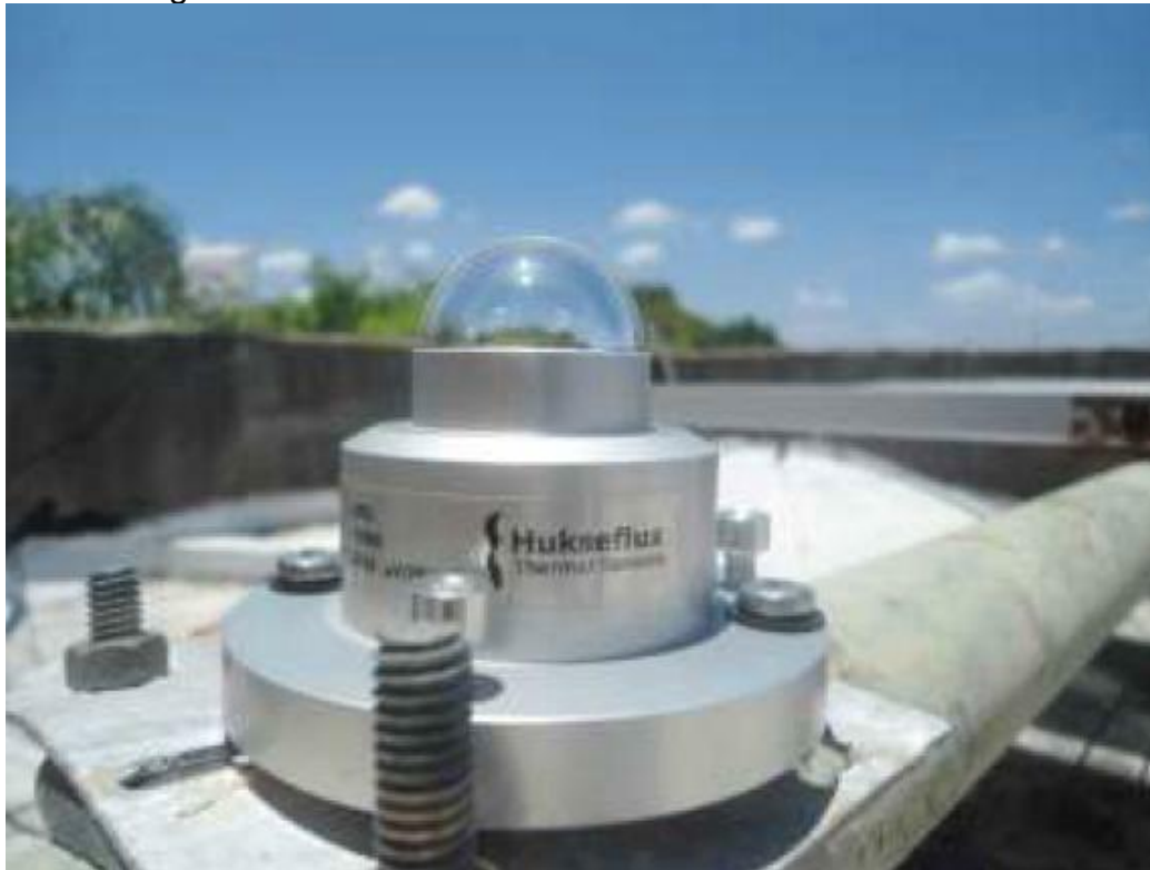
Figura 30 - Piranômetro modelo LP02 utilizado
