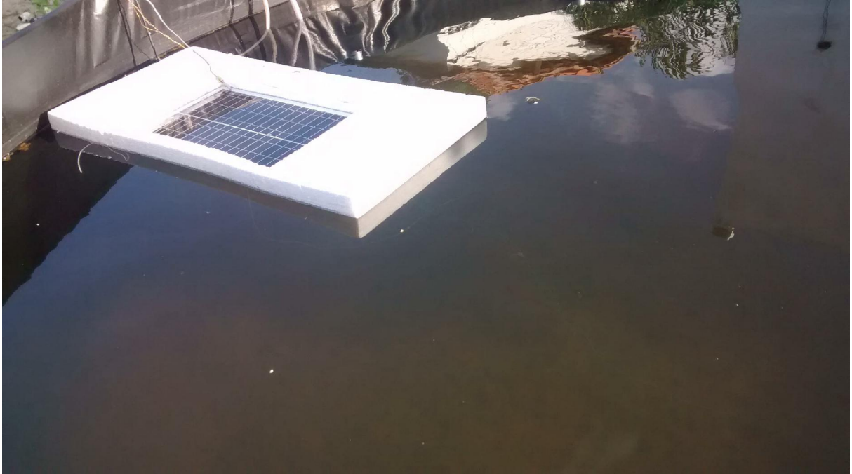
Figura 47 - Módulo FV flutuante com auxílio de isopor
