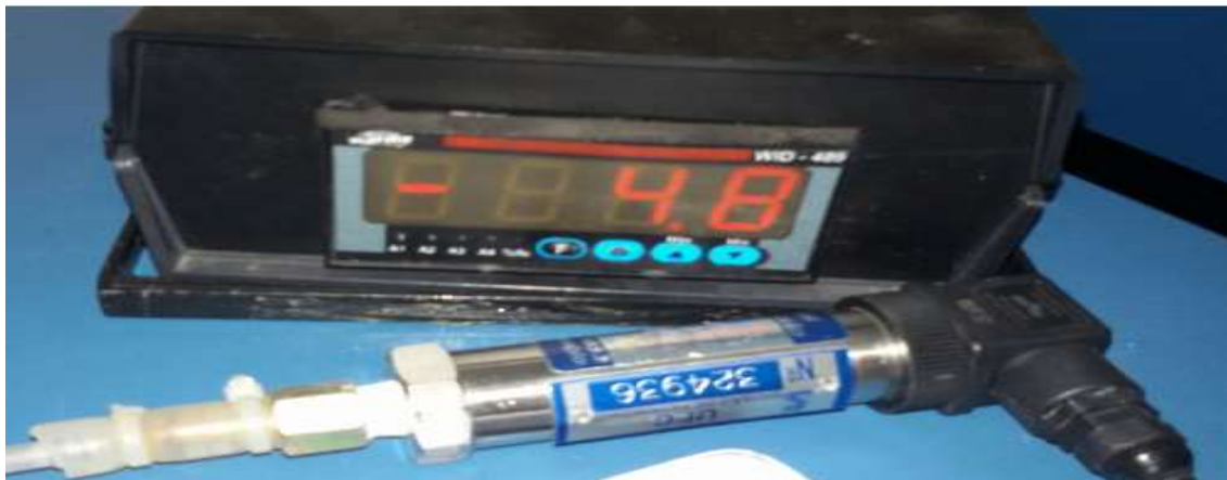
FIGURA 6 - Leitor de pressão em mBar, utilizado no teste de AME.
