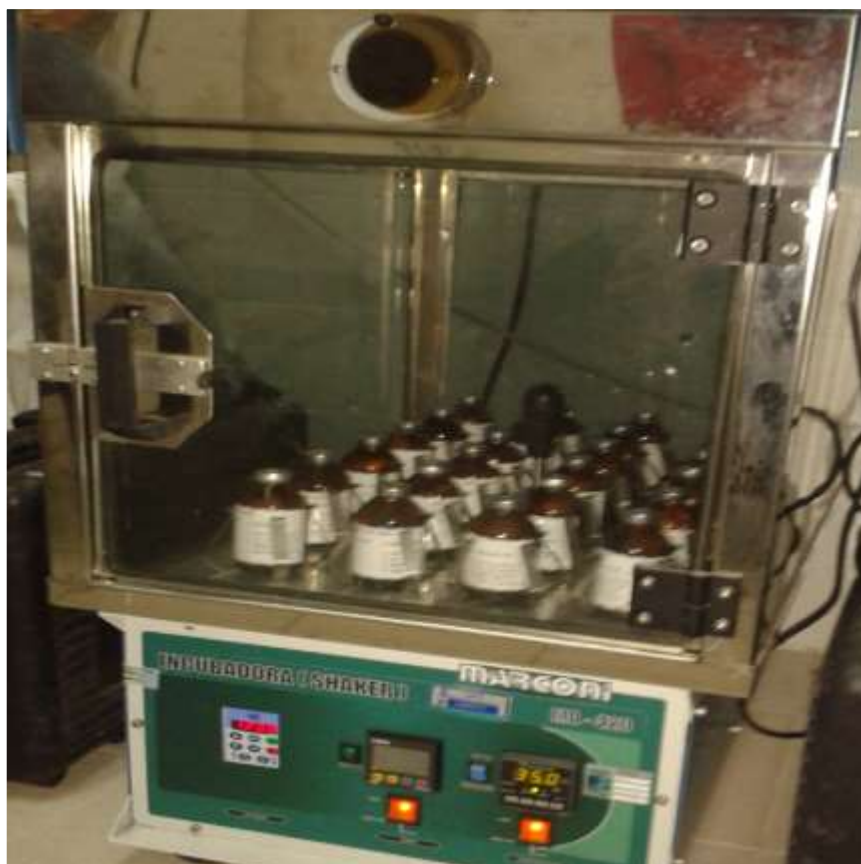
FIGURA 6 - Incubação dos frascos a agitação e temperatura controladas.
