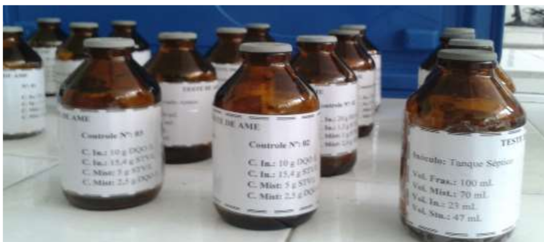
FIGURA 4 - Frascos preparados para realização do teste de AME.
