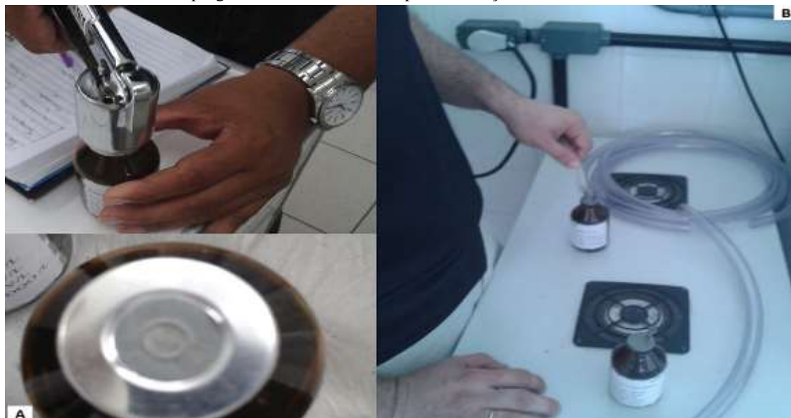
FIGURA 5 - Lacrando e purgando com N 2 os frascos para realização do teste de AME.
