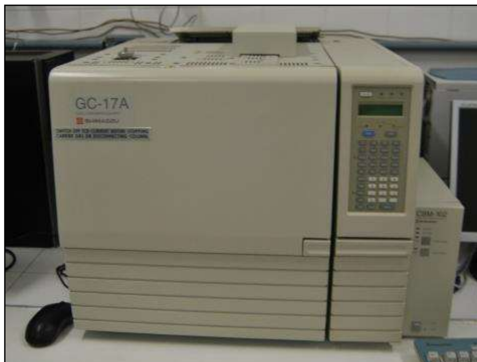
FIGURA 7- cromatógrafo GC 17A, marca Shimadzu, acoplado a um detector de condutividade térmica (TCD).
