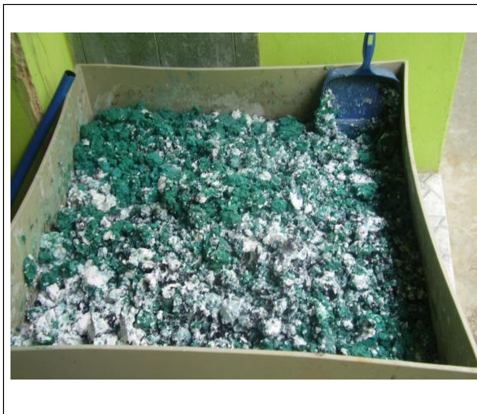
Figura 2 - Borra metálica gerada em função do tratamento da água residual das empresas fabricantes de joias folheadas de Juazeiro do Norte.
