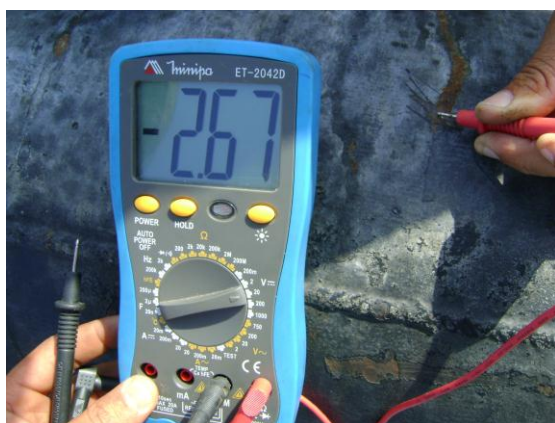
Foto 4.6 - Potencial estrutura/eletrólito com proteção (-2,67 Vcc)
