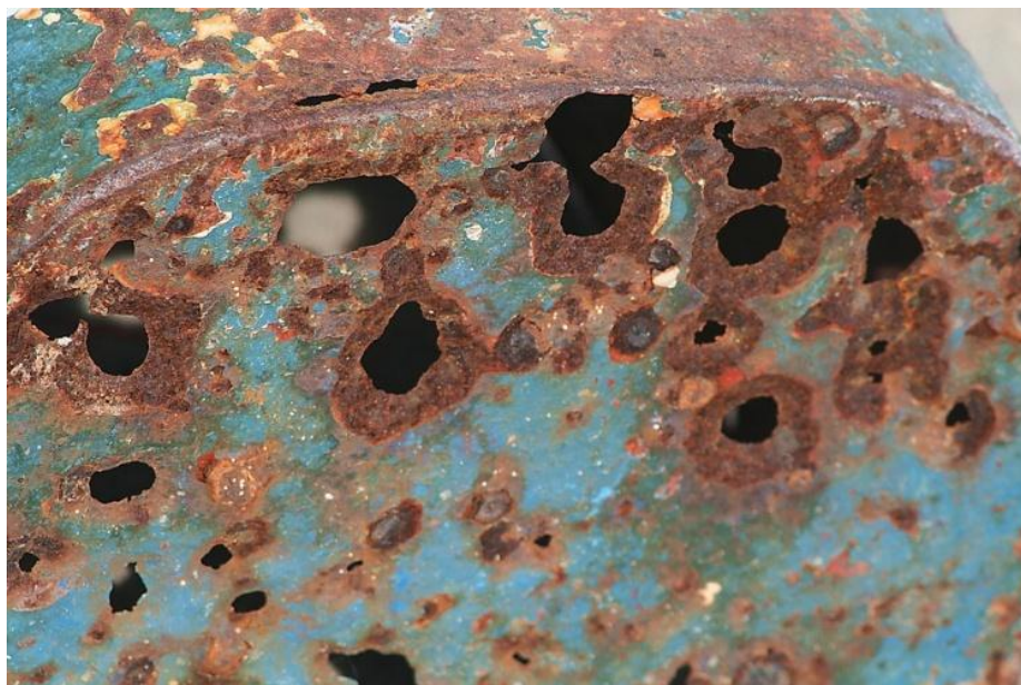
Figura 2.7 - Superfície sofrendo processo de corrosão
