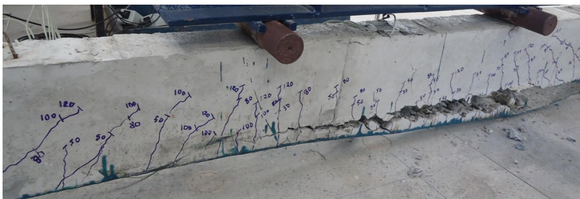
b) configuração da viga VB-5 na ruína
