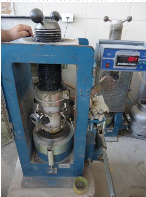
Figura 65 - Detalhes do ensaio de módulo de elasticidade no concreto
