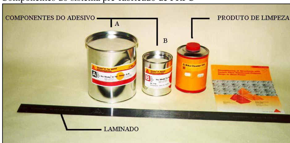
Figura 15 - Componentes do sistema pré-fabricado de PRFC
