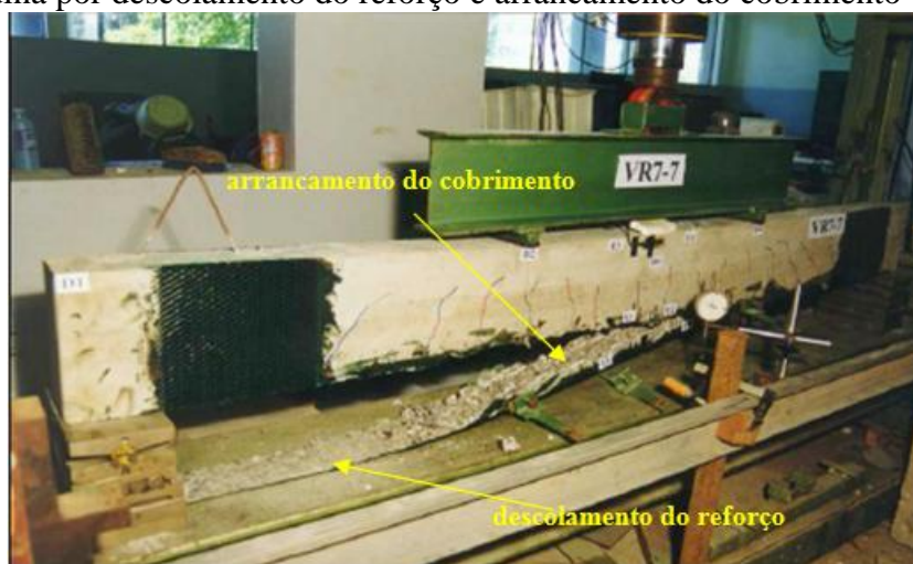
Figura 30 - Ruína por descolamento do reforço e arrancamento do cobrimento
