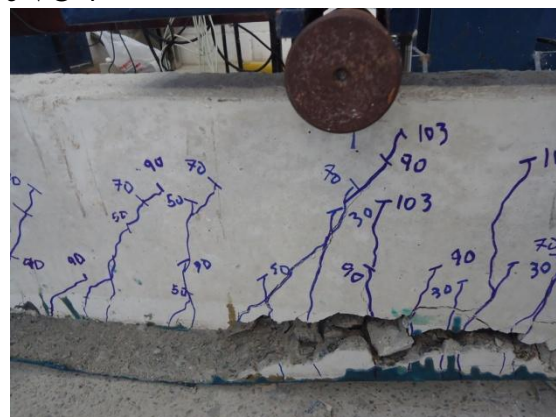
b) arrancamento do cobrimento (VC-4)
