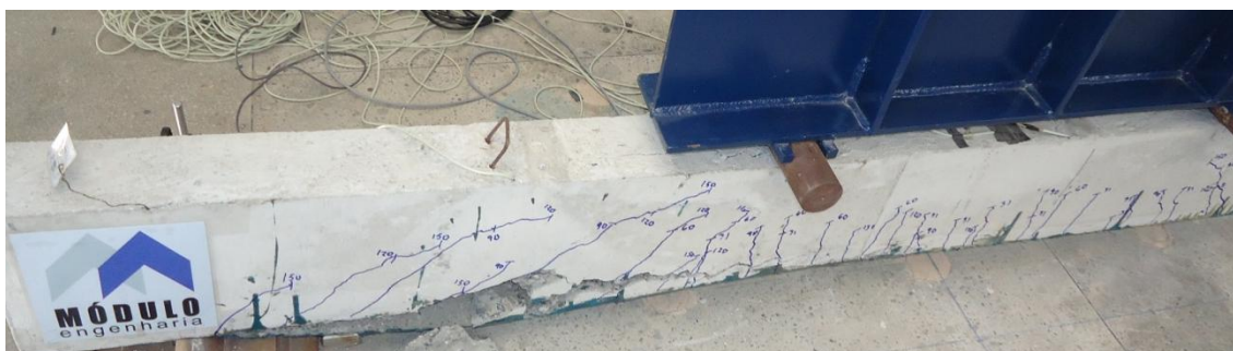
c) configuração da viga VA-5 na ruína
