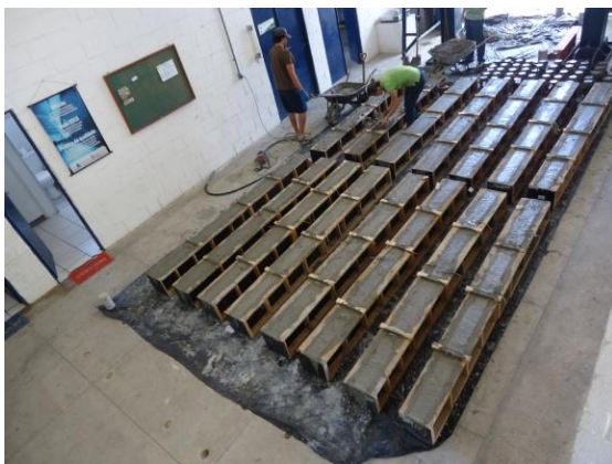
c) vigas concretadas
