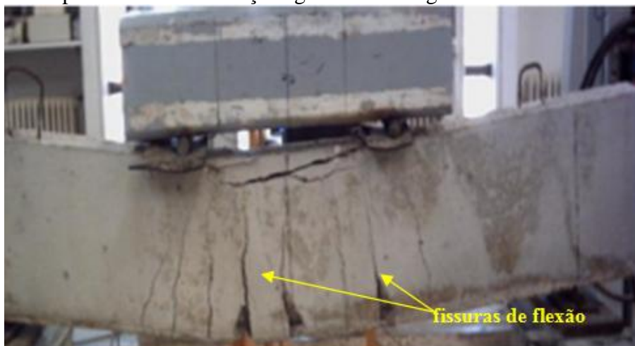
Figura 22 - Ruína por escoamento do aço seguido do esmagamento do concreto
