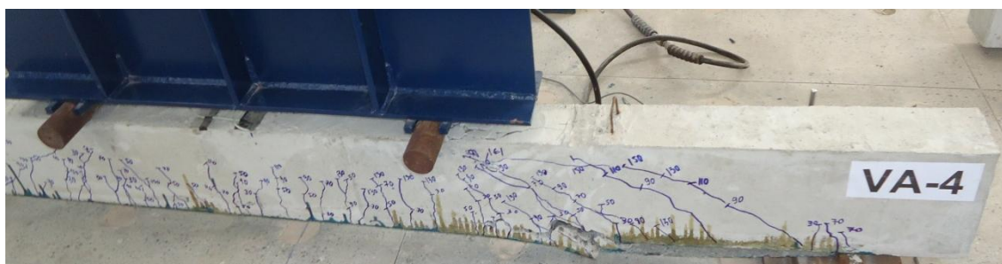
b) configuração da viga VA-4 na ruína
