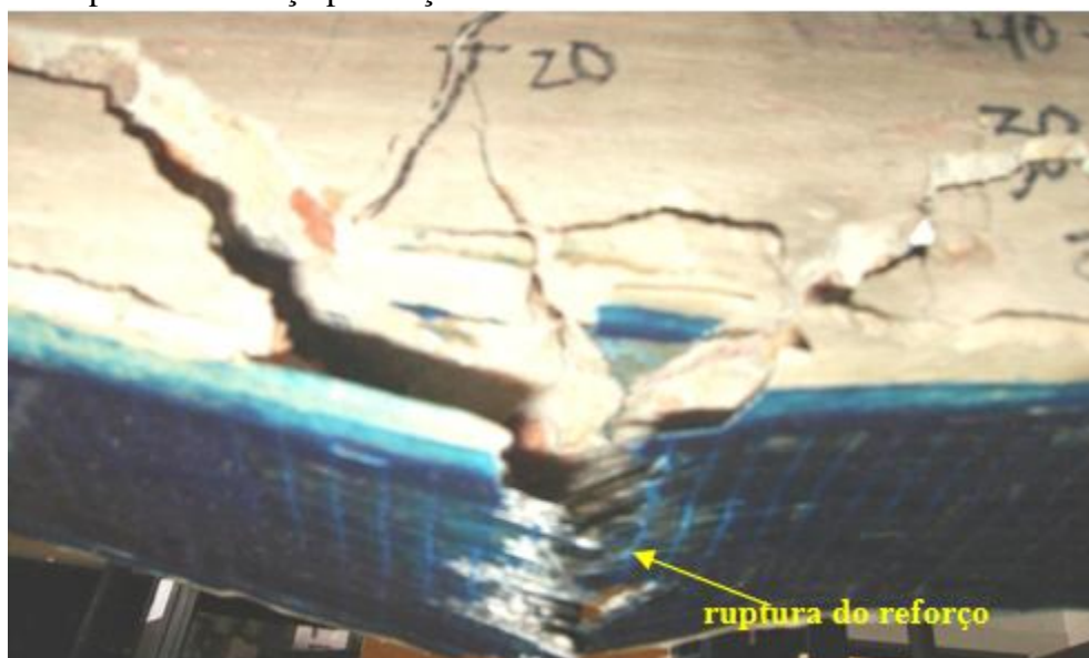
Figura 23 - Ruptura do reforço por tração
