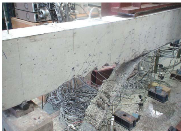
b) viga V1C na ruína
