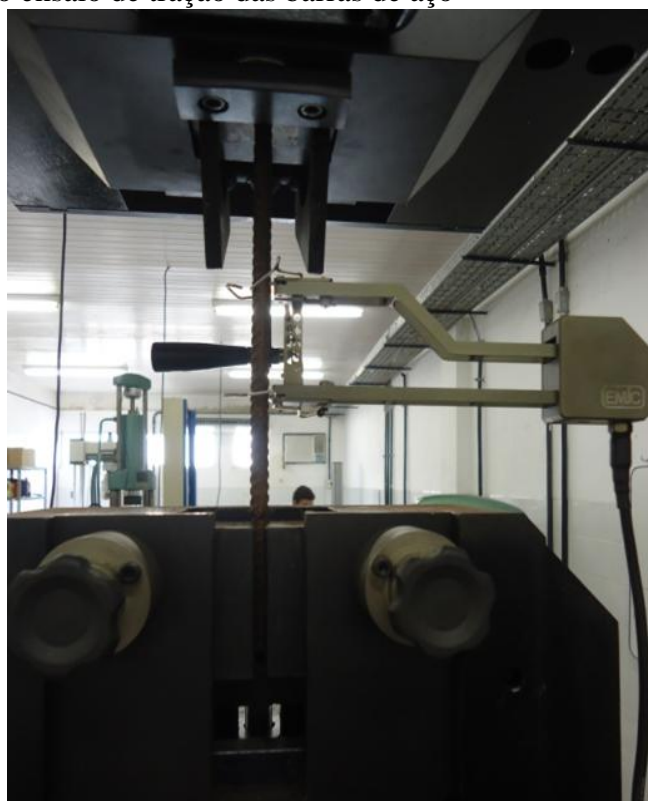
Figura 66 - Detalhe do ensaio de tração das barras de aço
