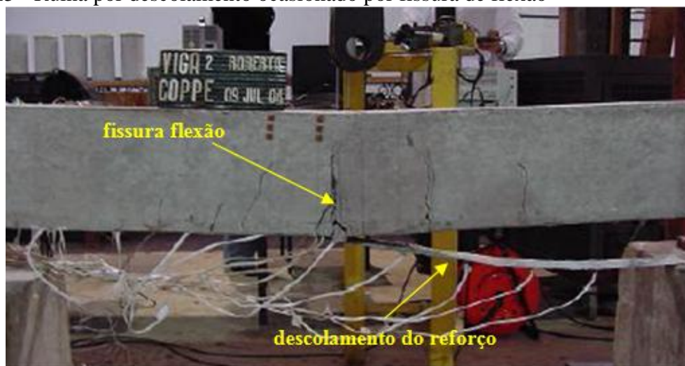
Figura 25 - Ruína por descolamento ocasionado por fissura de flexão
