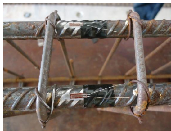
d) extensômetros colados na armadura
