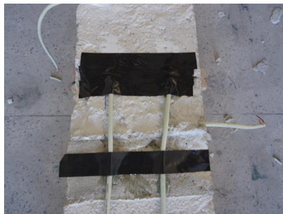
b) proteção com fita isolante
