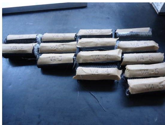
b) fibra de carbono para grupo de vigas
