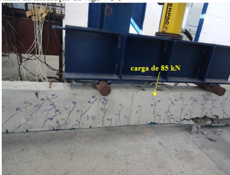
Figura 107 - Detalhe da fissuração da viga VC-5
