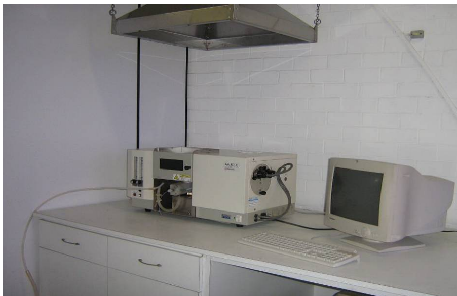
Figura 16 - Espectrometria de absorção atômica de chama modelo AA-6200 da Schimadzu.
