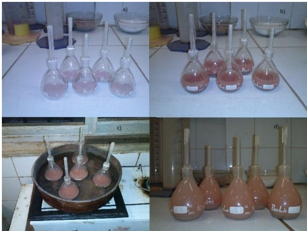
Figura 18 - Ensaio de densidade real a) picnômetro com solo b) picnômetro com solo e água c) aquecimento do picnômetro d) picnômetro com solo e cheio de água.
