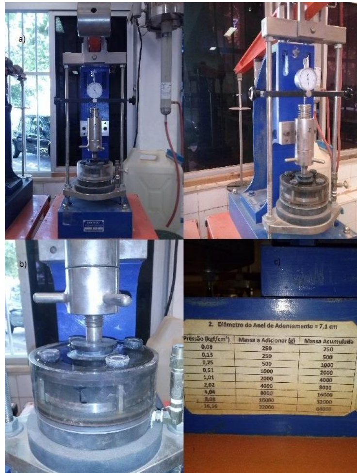
Figura 23 - Ensaio de adensamento a) Prensa devidamente equipada com a célula de adensamento (edômetro) b) corpo de prova moldado e saturado c) diâmetro do anel e pressões utilizadas no ensaio.
