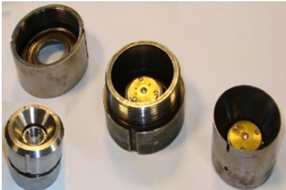
Figura 25: Capô, Corpo e Pistão (da esquerda para a direita) e Célula de pressão montada (parte inferior esquerda) [25].
