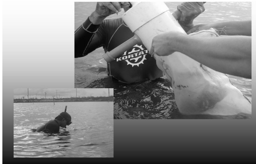
Figura 3 - Amostrador de PVC para coleta de sedimento nos fundos dos viveiros da fazenda de camarão localizada no município de Aracati, no entorno do estuário do Rio Jaguaribe, Ceará, Brasil.
