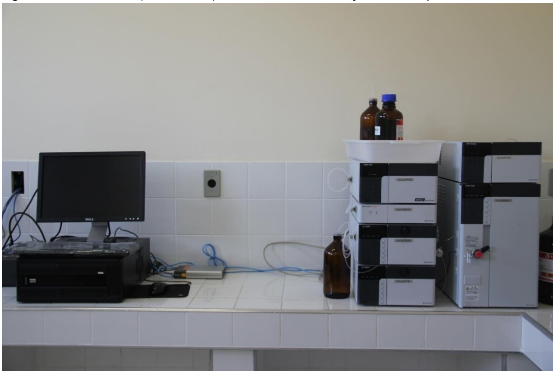
Figura 10– HPLC/DAD (SHIMADZU) utilizado na determinação dos compostos.
