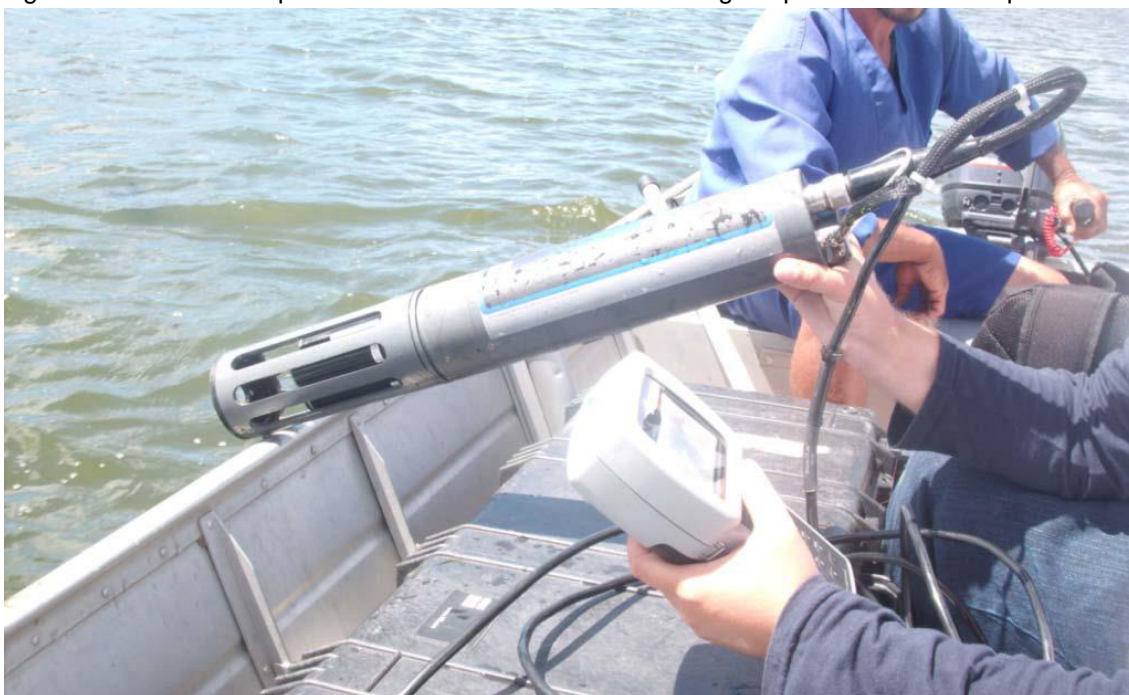
Figura 21 - Sonda multiparamétrica utilizada na análise de alguns parâmetros físico-químicos.
