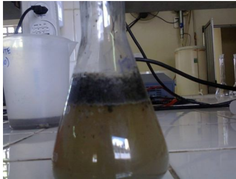
Figura 25: Lodo flotado, por acúmulo de gordura no reator UASB
