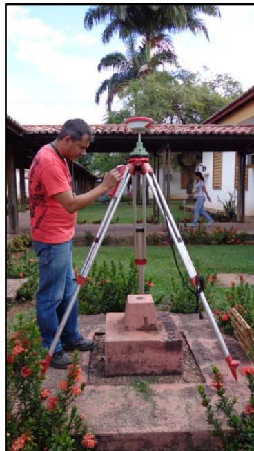
Figura 09: Instalação do GPS Geodésico modelo LEICA 9200 (Gps da Base)
