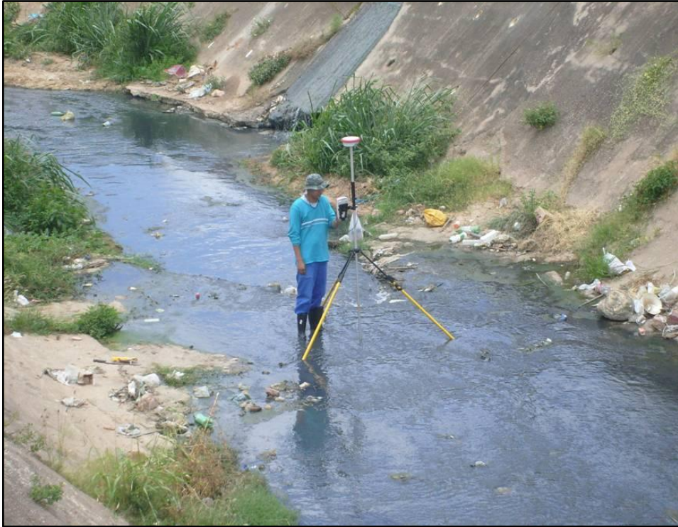
Figura 10: Levantamento do eixo do canal com o GPS Geodésico modelo LEICA 9200 (Gps Móvel)
