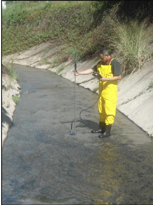
Figura 14: Aferição da vazão de entrada do canal do Rio Granjeiro com o medidor de fluxo para canais abertos modelo ultrasônico FLOWTRACK
