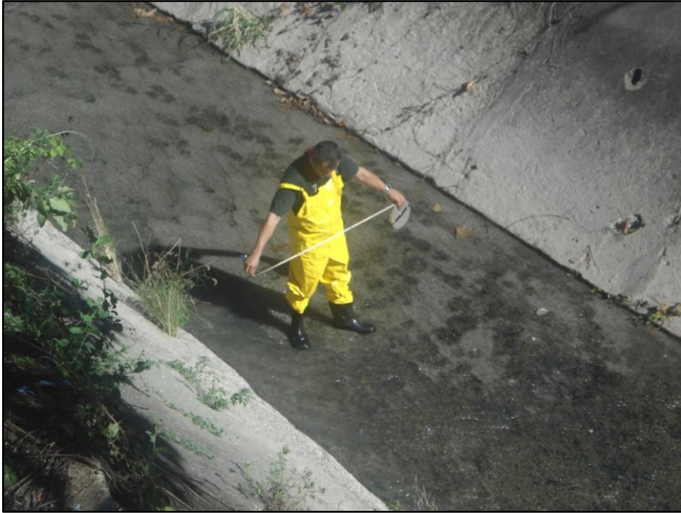
Figura 12: Medição das dimensões estruturais do canal do Rio Granjeiro
