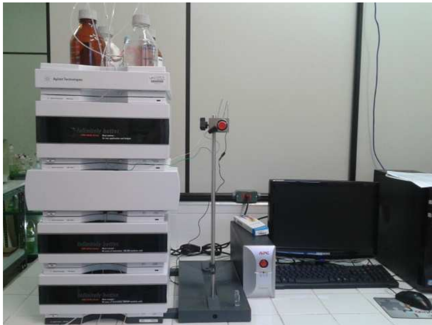
Figura 10 – Cromatógrafo Líquido de Alta Eficiência com detector de fluorescência (CLAE-FLD) utilizado na validação da metodologia para determinação das saxitoxinas
