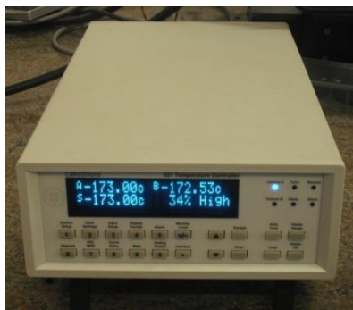
Figura 2.3.4 Elemento de controle de temperatura ( Heater ). [Observe as indicações dos sensores (termopares) de temperatura a e b ( -173\text{ }^{\circ}\text{C} ). s ( set ) é o valor desejado (programado) da temperatura. 34% se refere a uma potência gasta para que a amostra não seja mais resfriada do que o valor indicado por s .] 8
