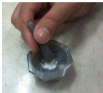
Figura 2.2.1. Os cristais coletados devem ser bem macerados até formar um pó. (na figura, pistilo e almofariz de ágata).
