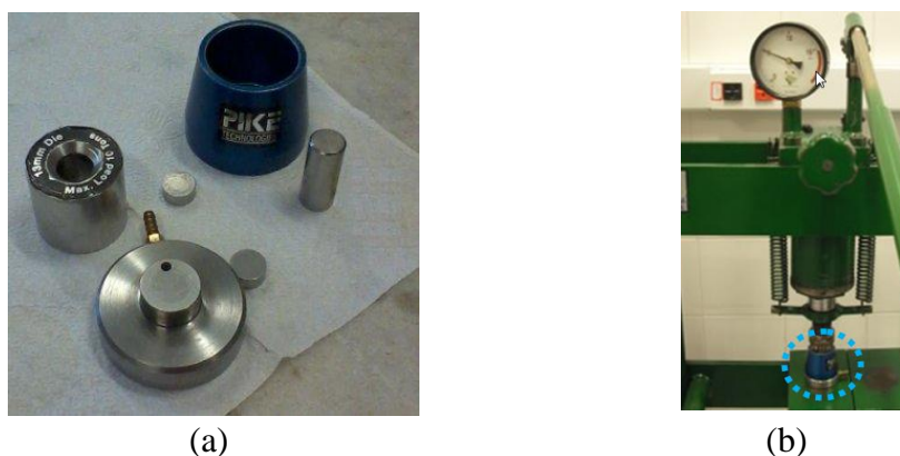
Figura 2.2.3. A mistura polietileno e amostra é montada no conjunto (a) e levada à prensa (b).
