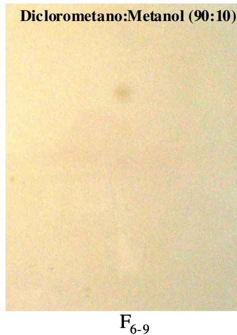
Figura 26 – Cromatografia em camada delgada da F 6-9 (F 14-16(6/9) ) oriundas do UFE – F 14-16 obtido da macroalga marinha verde Ulva fasciata , no sistema diclorometano:metanol (90:10, v/v).
