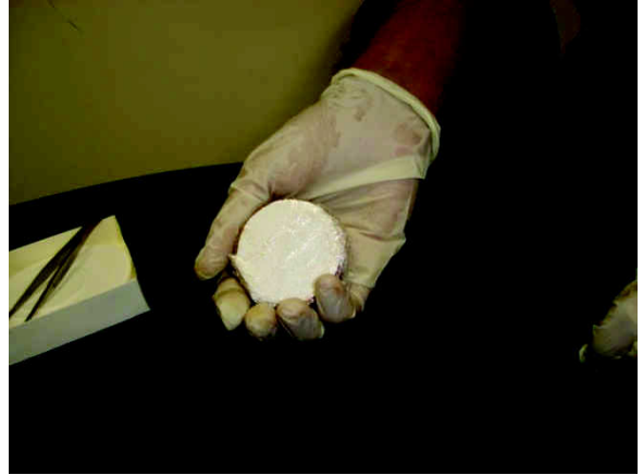
(b) Corpo de prova com papel filtro envolvido com o papel filme
