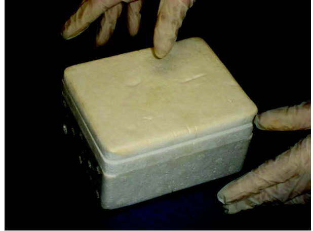
(b) Isolamento térmico dos corpos de prova
