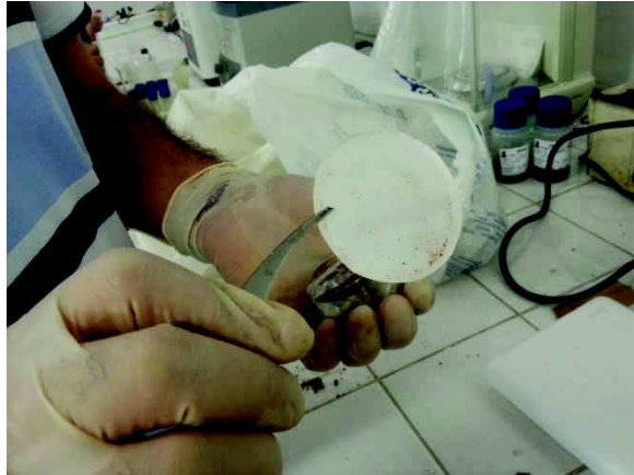
Figura 39 – Solo aderido ao papel filtro em contato com a amostra
