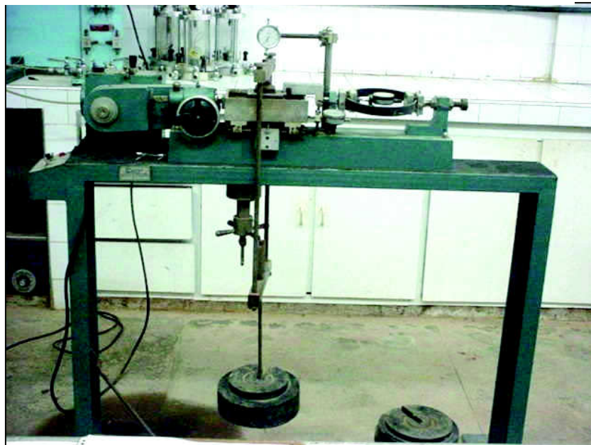
Figura 29 - Equipamento do ensaio de cisalhamento direto utilizado na pesquisa
