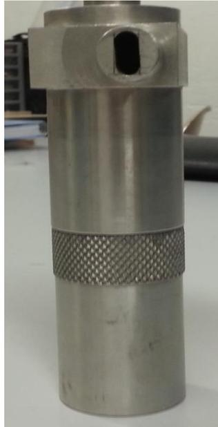
**Figura 5.9b** - Imagem da região inferior do ciclone separada do topo (rosqueável)
