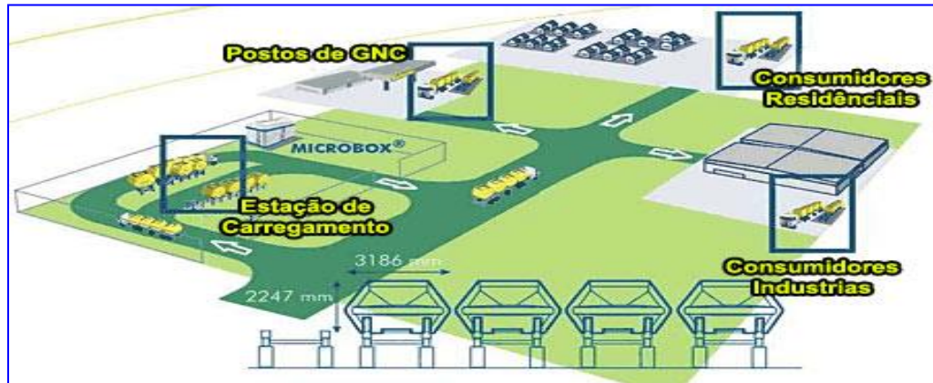
FIGURA 2.3- Funcionamento Sistema Modular de Transporte e Armazenamento
