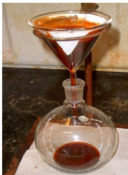
Figura 15: Filtração da resina para remoção de \text{Na}_2\text{SO}_4
