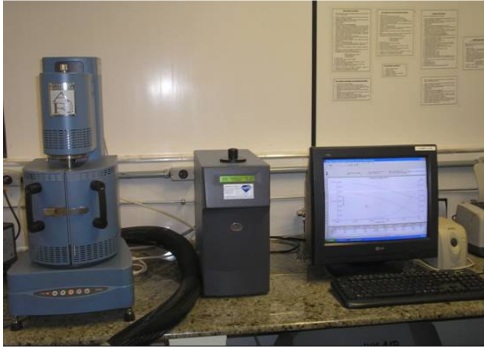
Figura 18: Equipamento utilizado nos ensaios dinâmicos-mecânicos.
