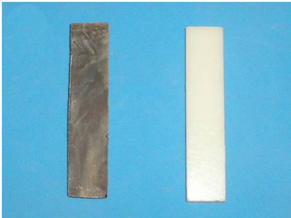
Figura 17: Corpo de prova padrão (compósito à esquerda, padrão à direita).
