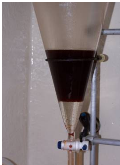
Figura 14: Extração de água produzida na preparação do Resol.
