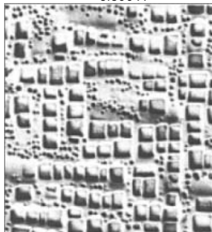
Figura 3.8. Fase \gamma' com morfologia cuboidal – liga Udimet 700 tratada termicamente. Aumento: 6.800 X
