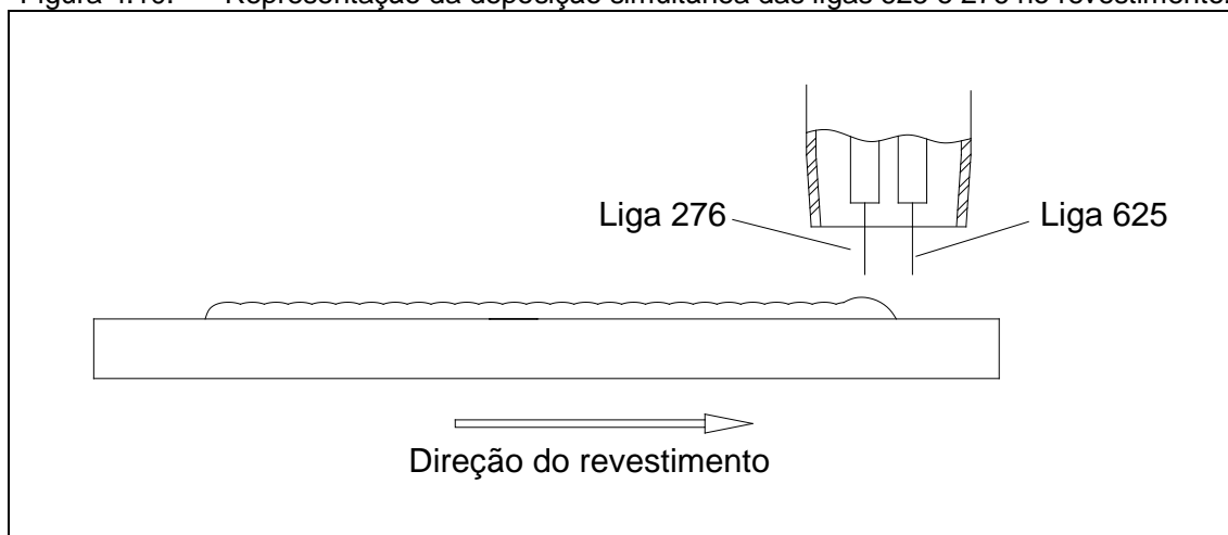
Figura 4.10. Representação da deposição simultânea das ligas 625 e 276 no revestimento.
