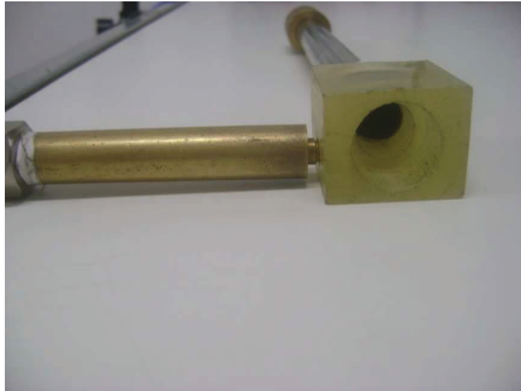
Figura 7.10 – Fotografia do tubo de admissão de ar comprimido rosqueado à câmara de vórtice
