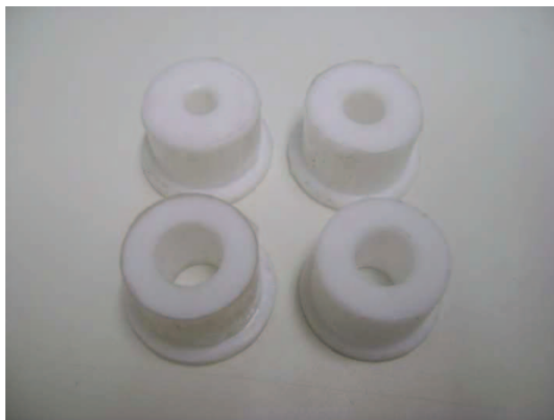
Figura 7.11 – Fotografia dos diafragmas com diâmetros de orifício de 0,4D ; 0,5D ; 0,6D e 0,7D
