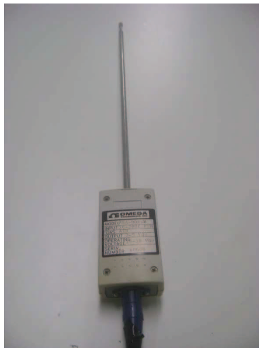
Figura H.4 – Fotografia do sensor de velocidade utilizado na medição da velocidade da corrente ar frio
