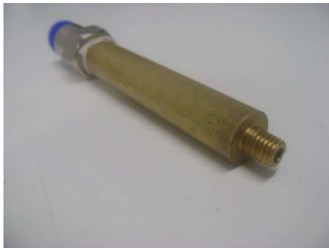
Figura 7.9 – Fotografia do bocal de entrada construído a partir de um tarugo de latão de base circular
