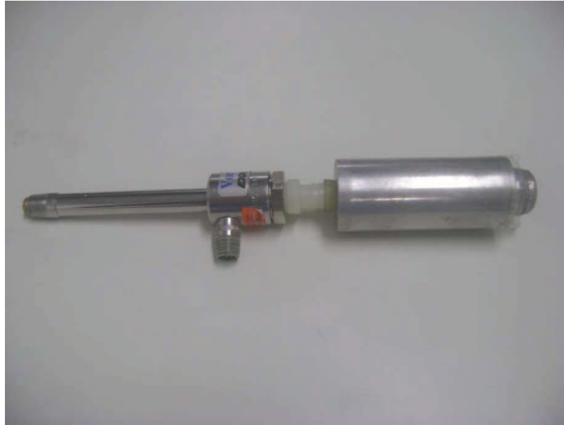
Figura 5.2 – Fotografia do tubo de vórtice comercial acoplado ao atenuador de ruído ( muffler )
