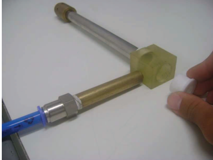
Figura 7.12 – Fotografia do diafragma sendo acoplado à câmara de vórtice
