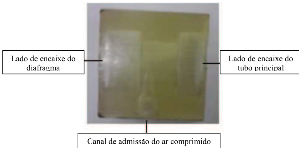
Figura 7.7 – Fotografia da câmara de vórtice construída pela impressora 3D
