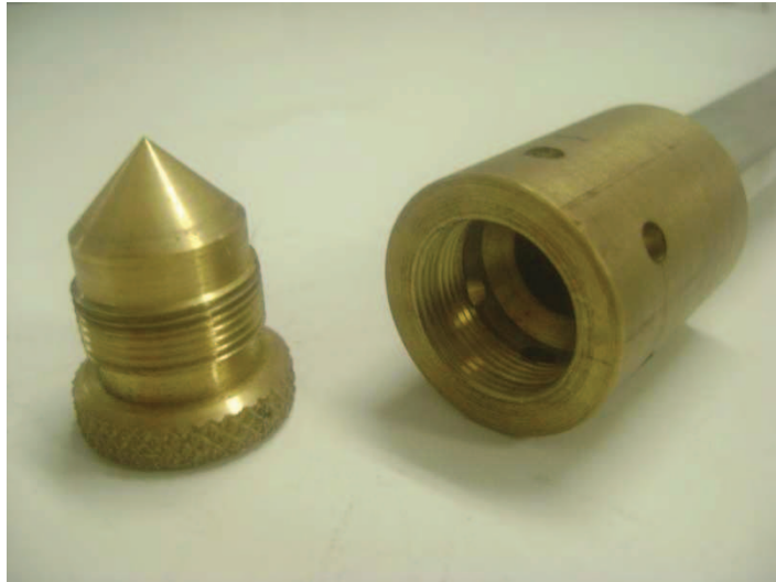
Figura 7.1 – Fotografia do tubo com orifícios e válvula de controle de fluxo do tipo cônica
