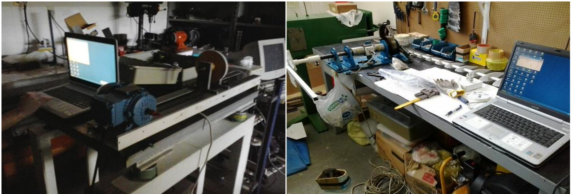
Figura 36 – Calibração do Tacômetro (esq.) e transdutor de torque (dir.).
