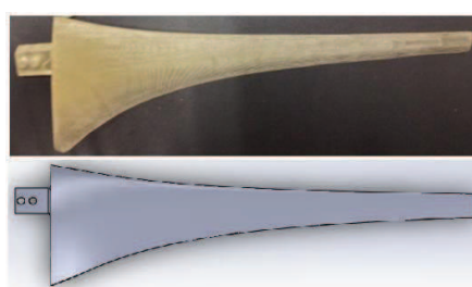
(b) Desenho em CAD e foto da Pá de \lambda_p = 7 .
