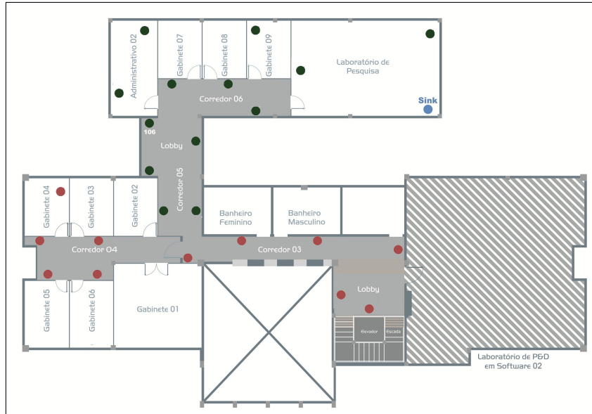
Figura 5 – Rede implantada com servidor posicionado na extremidade.
