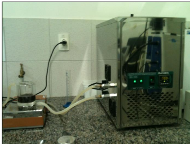
Figura 6 - Reator encamisado utilizado na hidrólise da casca de coco com enzimas produzidas por Melanoporia sp.
