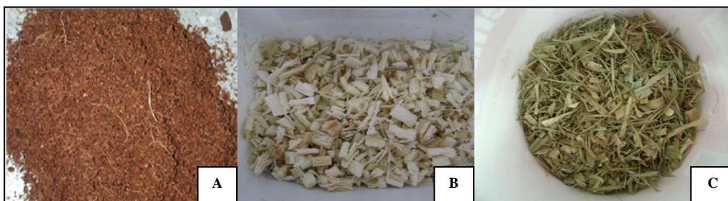
Figura 3 - Pó da casca do coco (A), bagaço de cana-de-açúcar (B) e palha de cana-de-açúcar (C) utilizados nos processos fermentativos.
