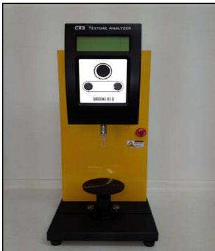
**Figura1** - Texturômetro de bancada (Texture Analyzer ct3 Brookfield).
