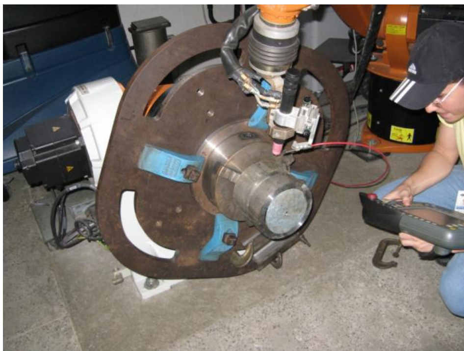
Figura 32 - Posicionamento da mesa no momento da soldagem.
