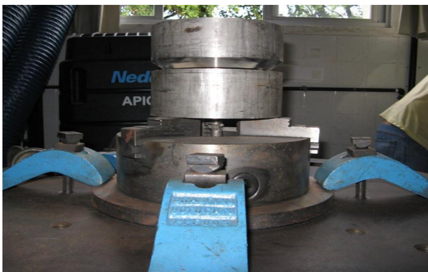
Figura 31 - Detalhe da montagem dos tubos na bancada de soldagem.
