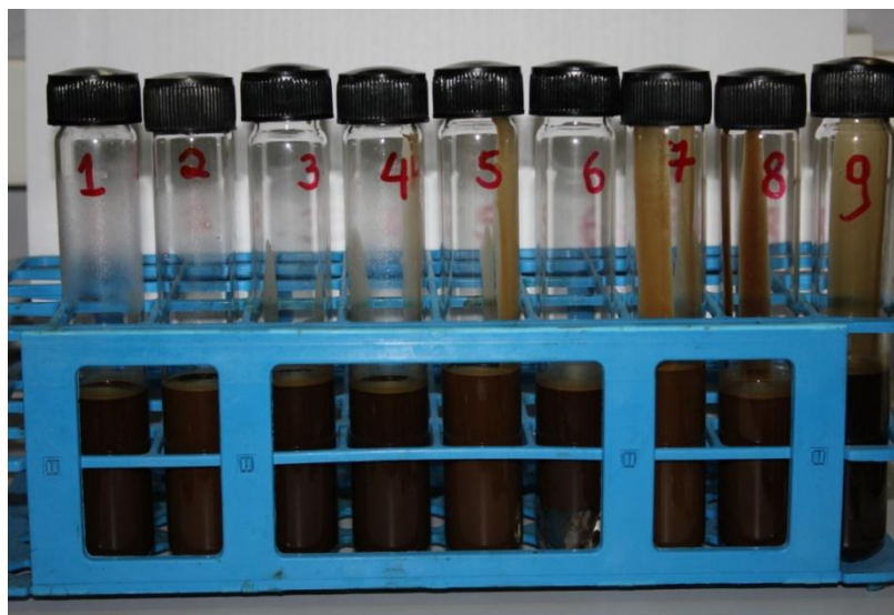
Figura 98 – Peças imersas nas emulsões de petróleo.
