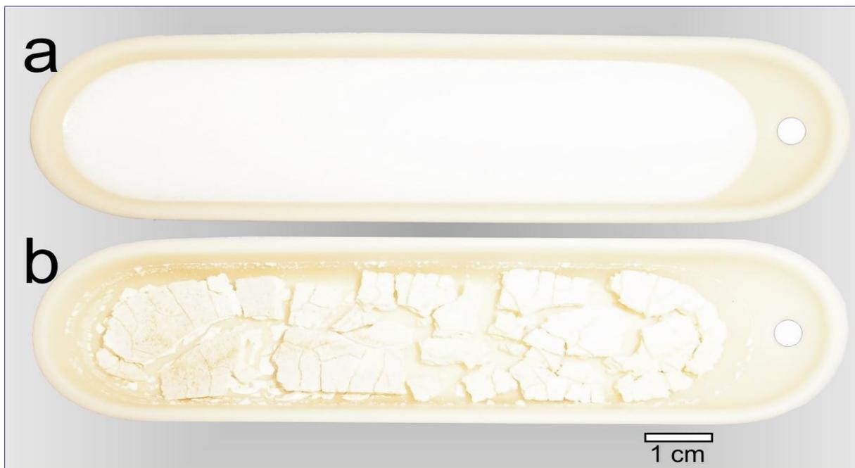
Figura 26. Amostra PS-F4c a) antes e b) após a calcinação.
