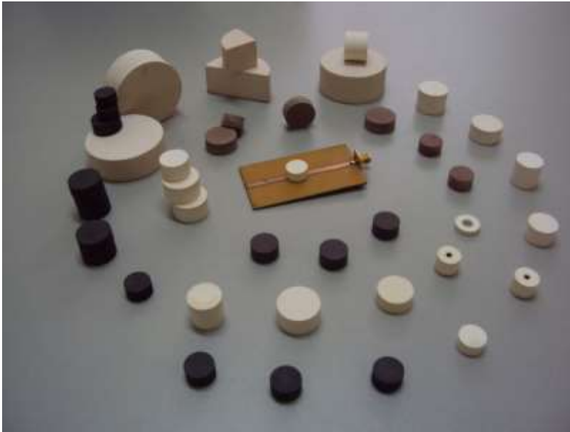
Figura 8. Diferentes geometrias para os DRs, com as formas cilíndrica, retangular, hemisférica, esférica e as de baixo perfil: discos circulares e triangulares.
