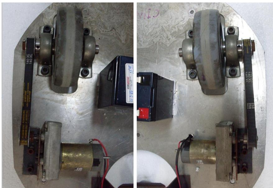
Figura A-28: Fotografia da montagem dos suportes dos motores, revelando desalinhamento entre as correias sincronizadoras.
