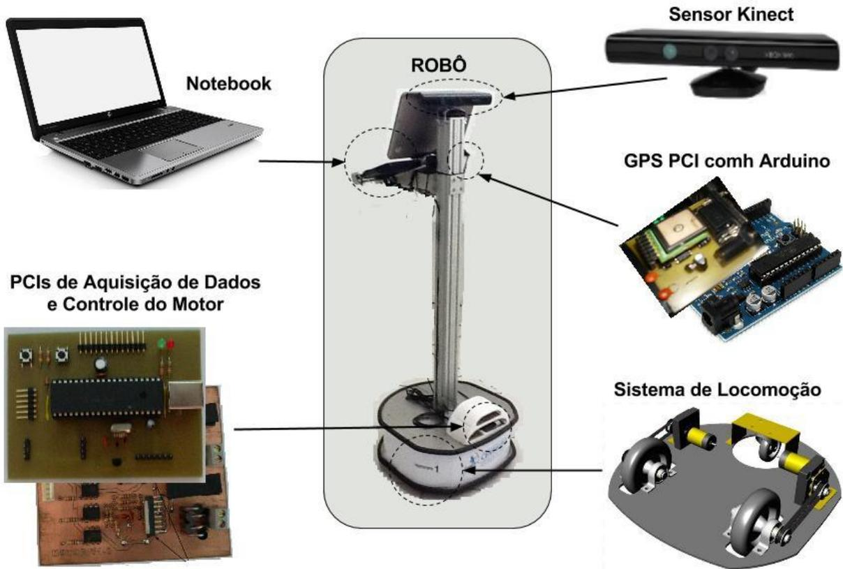
Figura 4.1 - Robô móvel com rodas construído como plataforma para a investigação, desenvolvimento e validação experimental do *middleware* proposto.
