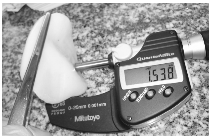
Figura 8 - Determinação da espessura da película de CB em micrômetro digital.
