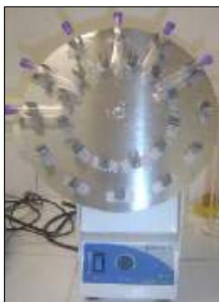
**Figura 2.3** Sistema de agitação rotatória TECNAL, modelo TE-165, utilizado nos ensaios em batelada.
