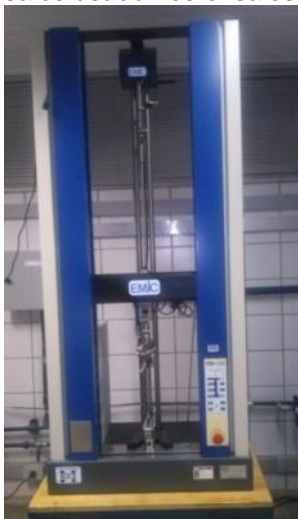
Figura 4.6 — Máquina Universal de ensaios usado nos ensaios de tração.
