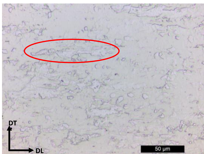
Figura 5.1 — Micrografia da amostra retirada na temperatura de 730 °C. Ataque Nital 4%.
