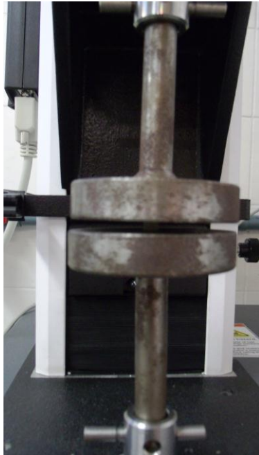
Figura 8 - Aparato usado para o ensaio de compressão diametral
