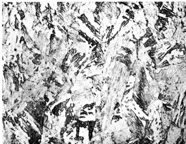
Figura 4 – Microestrutura martensítica na forma de ripas num aço maraging 18% Ni solubilizado por 3,6 ks a 1088 K.
