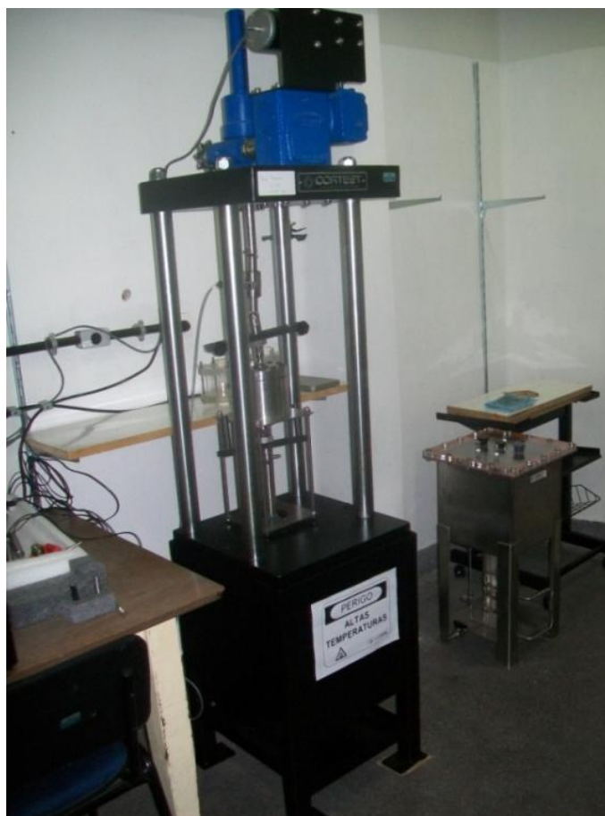
Figura 20 – Máquina de tração utilizada para realizar os ensaios BTB.
