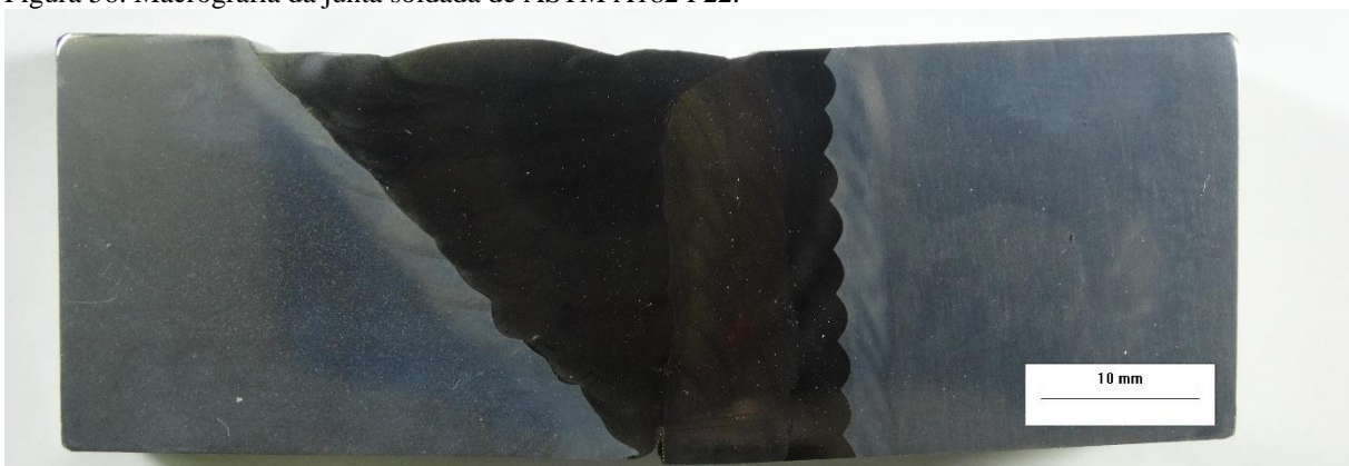
Figura 56. Macrografia da junta soldada de ASTM A182 F22.
