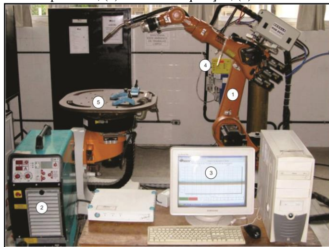
Figura 23. Equipamentos utilizados no enchimento das juntas: (1) robô industrial com tocha e alimentador arame-eletrodo; (2) fonte eletrônica multiprocesso; (3) sistema de aquisição; (4) medidor de Valim; (5) mesa de trabalho.
