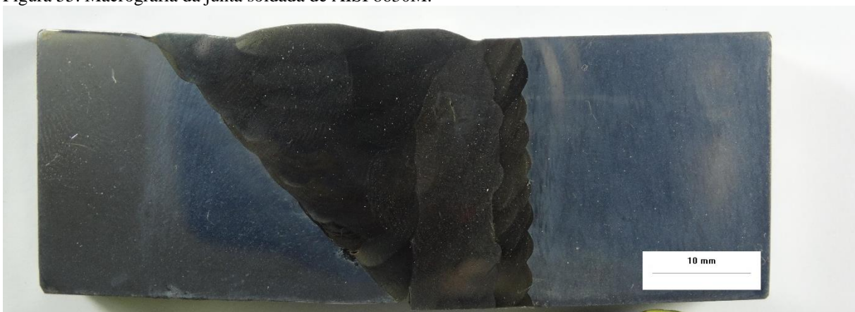
Figura 55. Macrografia da junta soldada de AISI 8630M.
