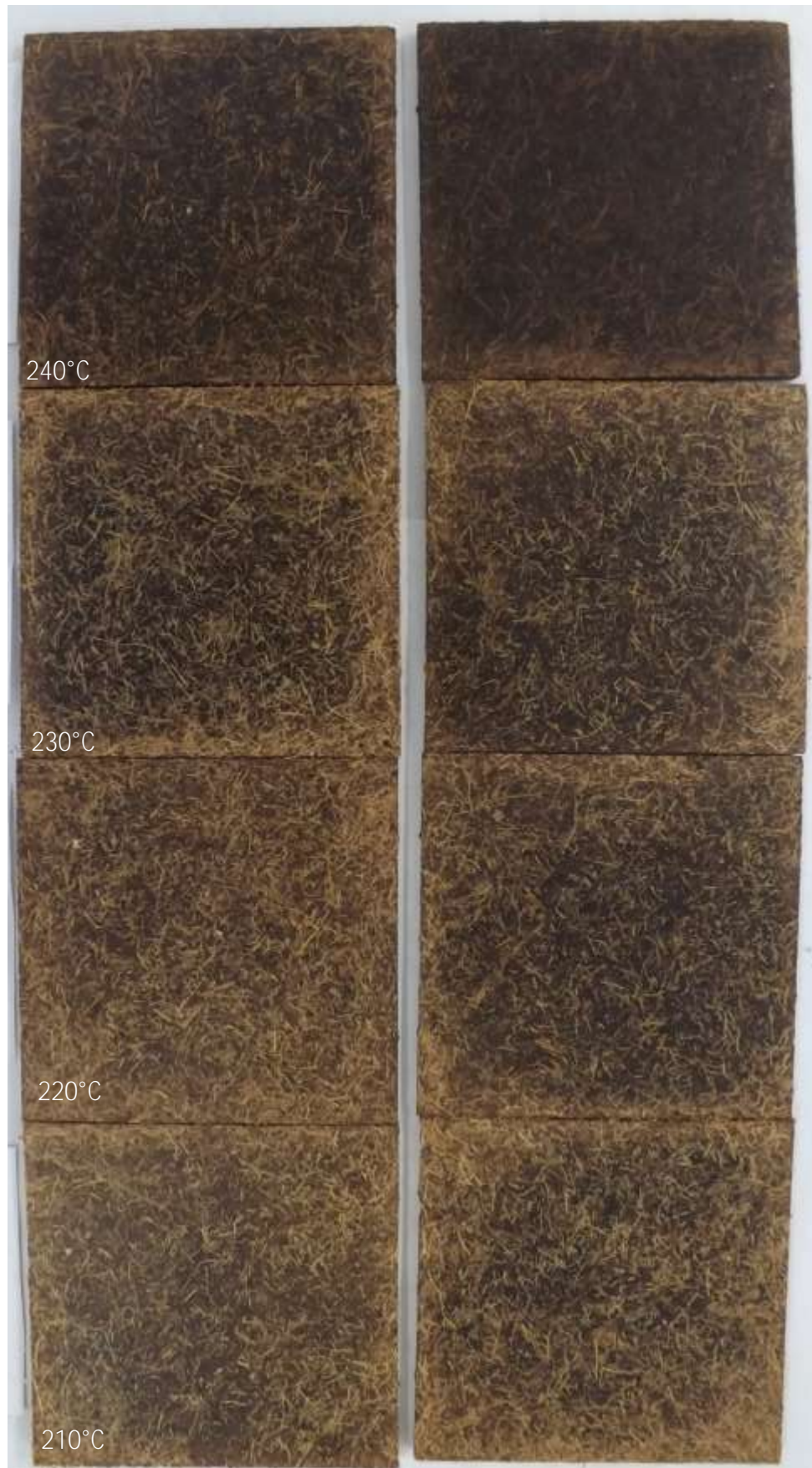
Figura 29 - Painéis produzidos a diferentes temperaturas.
