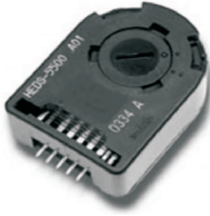
Figura B.6: Encoder incremental HEDS-5500 A11 da Avago®
