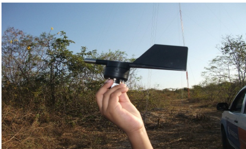
Figura 4.8 – Sensor de direção instalado na torre de Maracanaú – CE.
