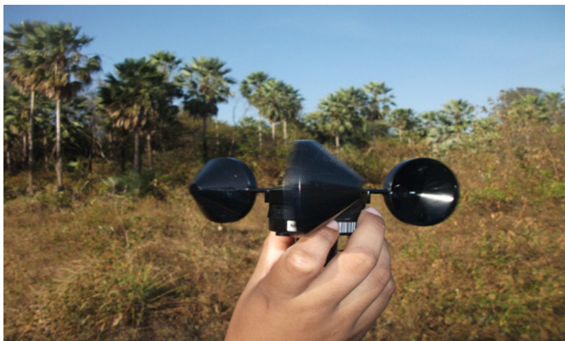
Figura 4.6 – Anemômetro Instalado nas torres.
