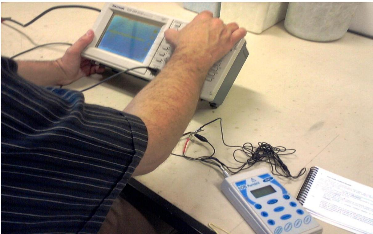
**Figura 12** – confirmação de calibre do eletroestimulador modelo EL 608 em aparelho Osciloscópio no Laboratório do Departamento de Física da UFC
