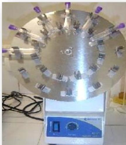
Foram realizados, preliminarmente, ensaios de adsorção para a determinação da concentração do adsorbato no sobrenadante após atingir equilíbrio, para fins de comparação com os resultados das concentrações depois do processo de eluição. A tubos contendo 1 g de adsorvente foram adicionados 10 mL de solução de ácido láctico em uma concentração conhecida (12%). O sistema permaneceu sob agitação durante 180 min. Em seguida, alíquotas do sobrenadante foram retiradas e analisadas por CG.
