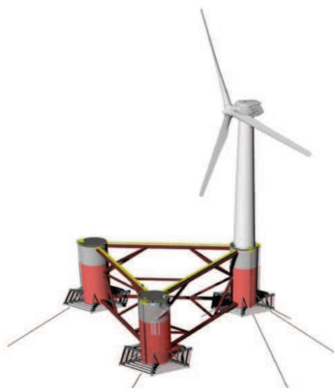
Figura 1.14: Turbina Eólica Semi-submersível com Torre Acoplada a Uma Só Coluna
