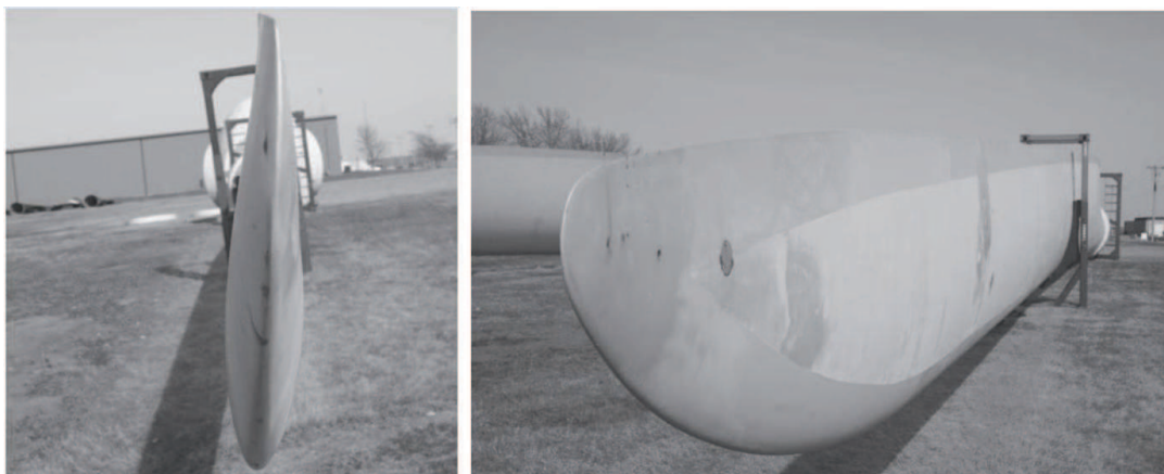
Figura 1.7: Pá de Turbina Eólica de 134,5 ft de Comprimento.
